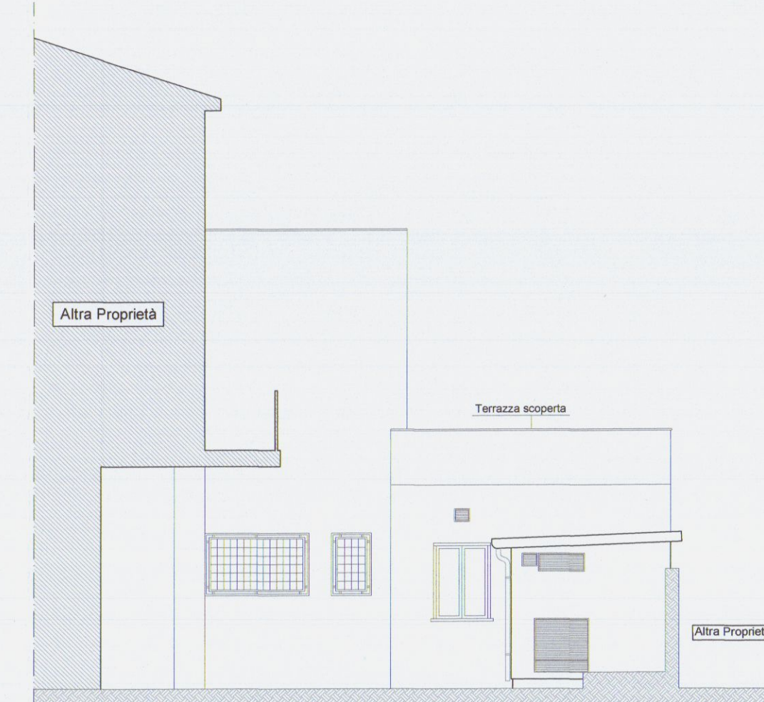
Prospetto Nord - Ovest - Scala 1: 100
