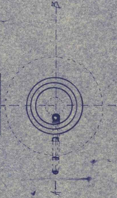
TIPO DI POZZETTO PERDENTE
