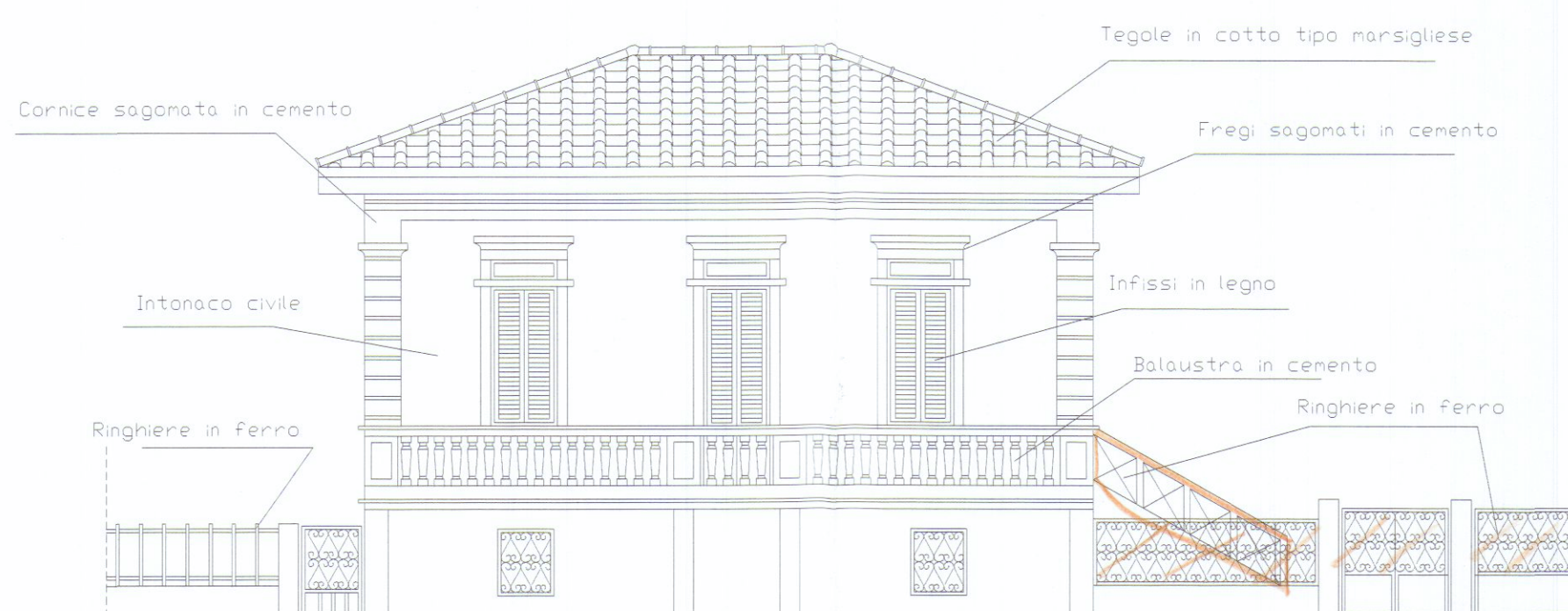
PROSPETTO NORD ESISTENTE conc. 202/99
