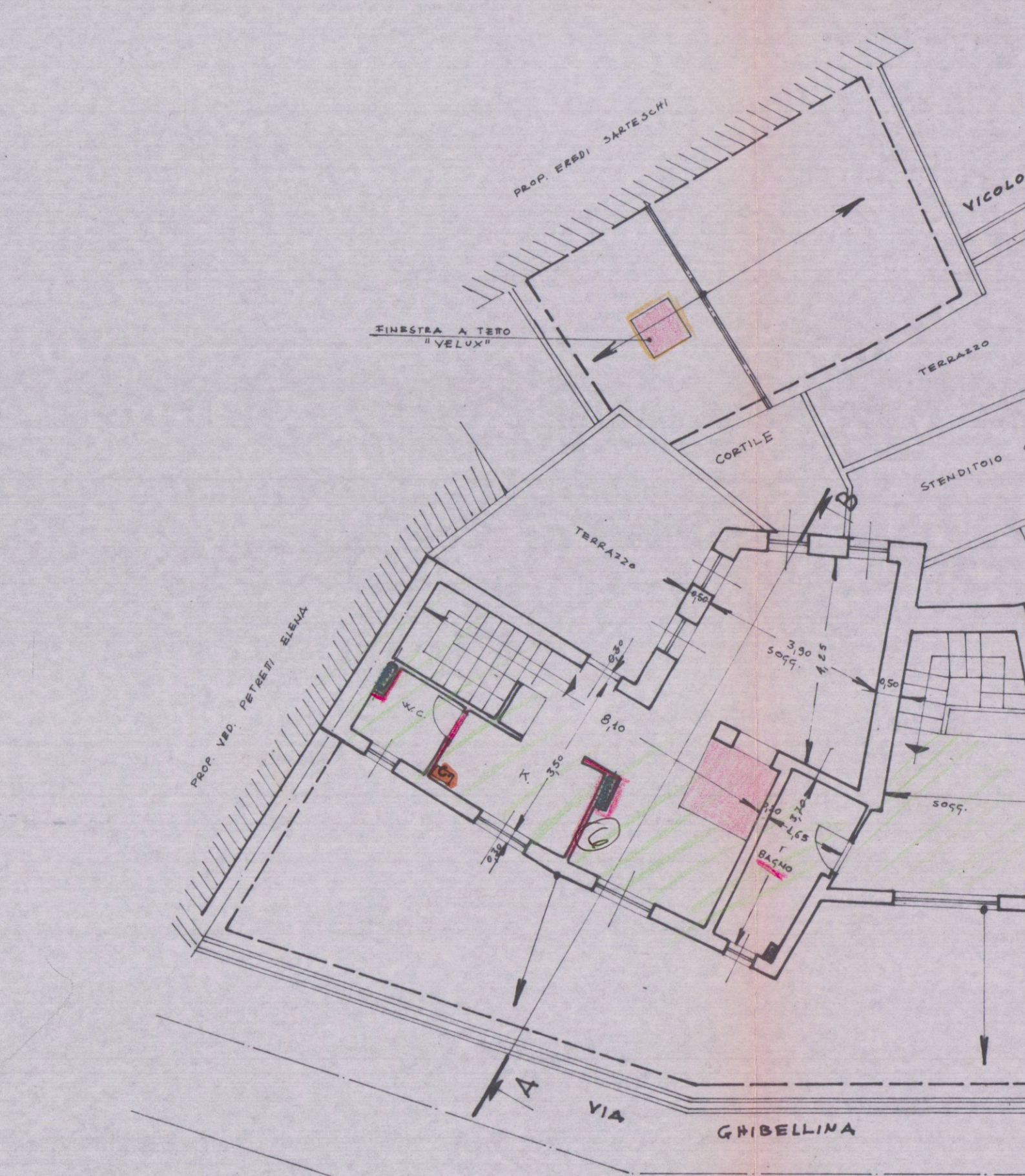
PIANTA DEL SOTTOTETTO E TETTO
