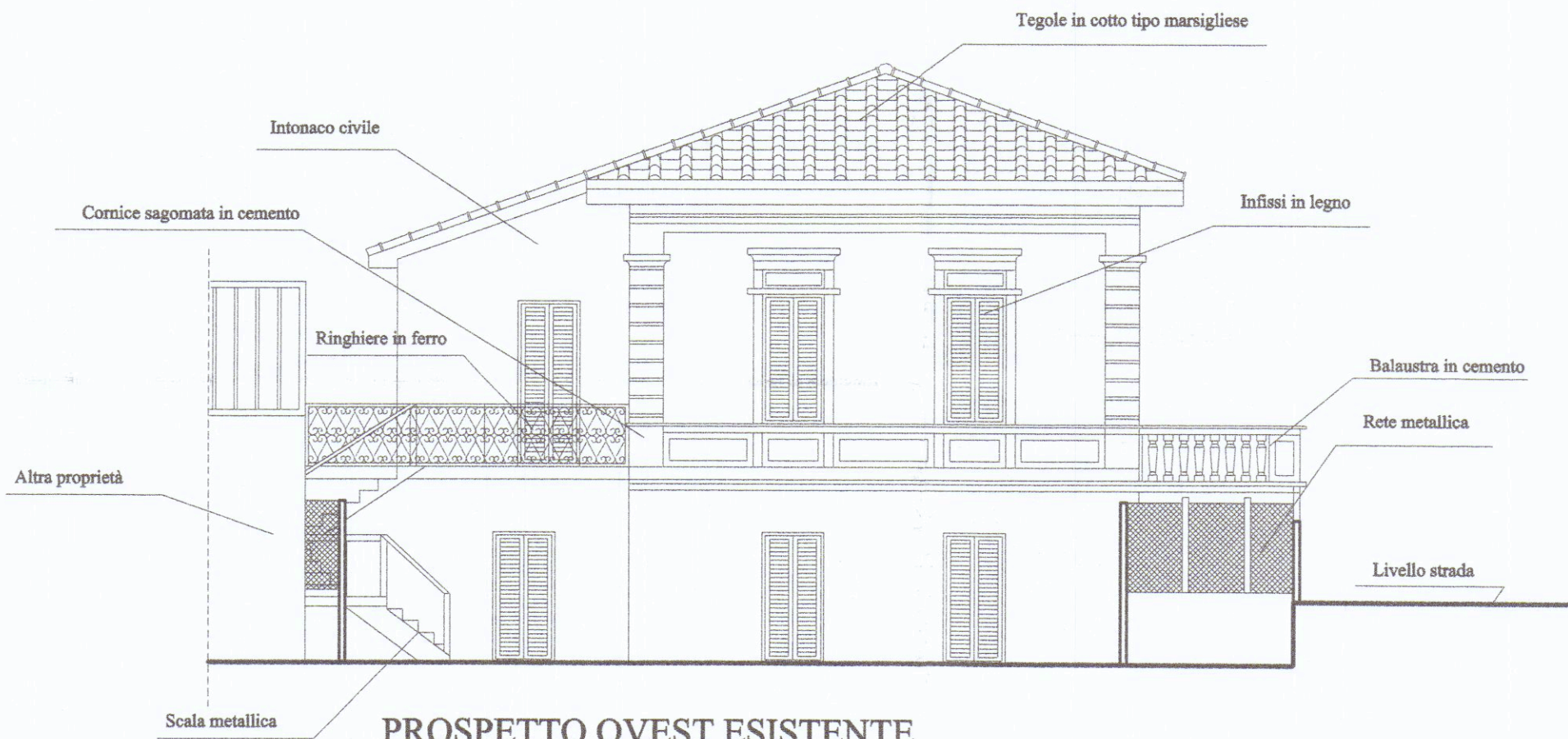
PROSPETTO OVEST ESISTENTE
