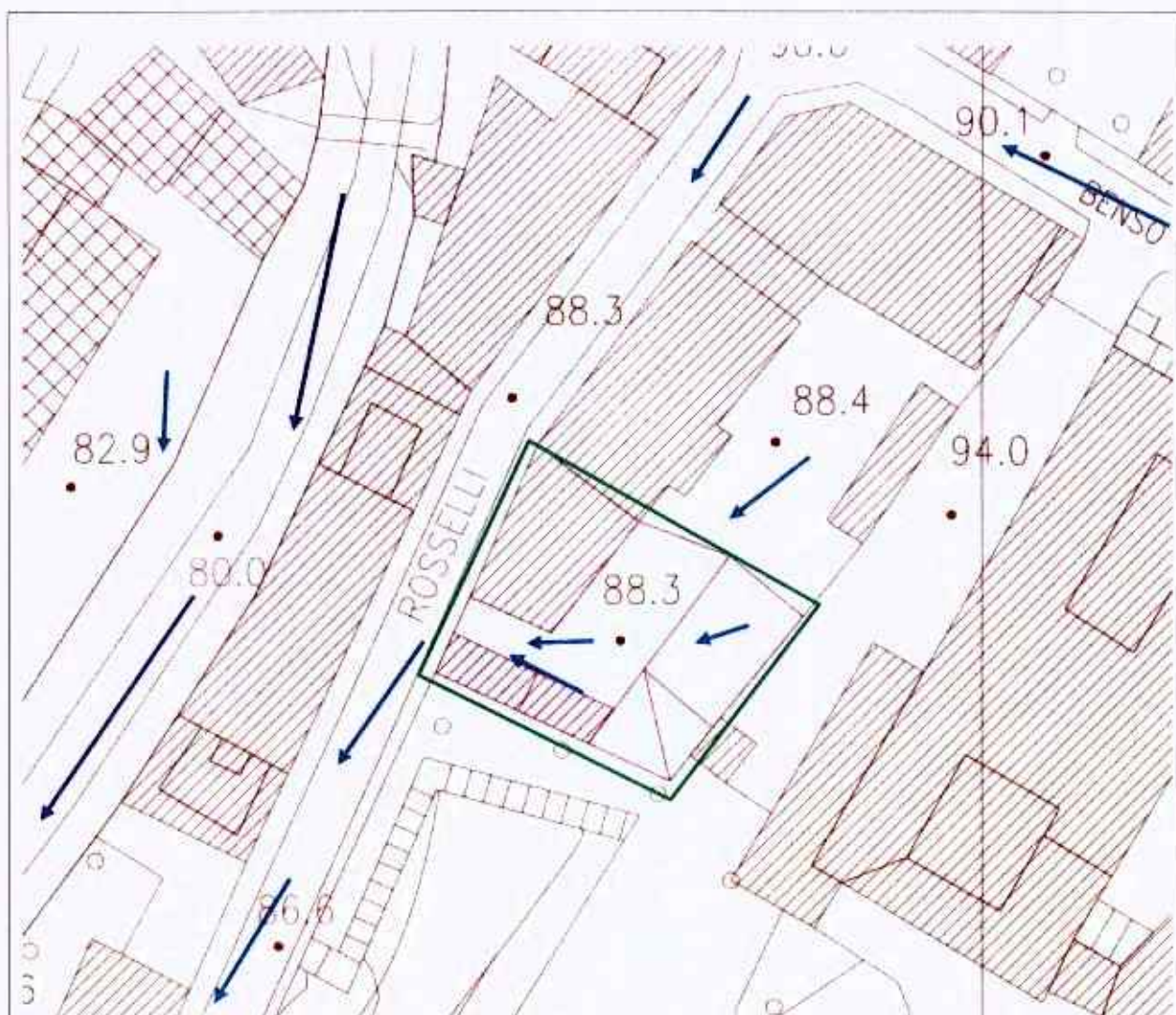
Figura 3: topografia di dettaglio - scala 1:500
