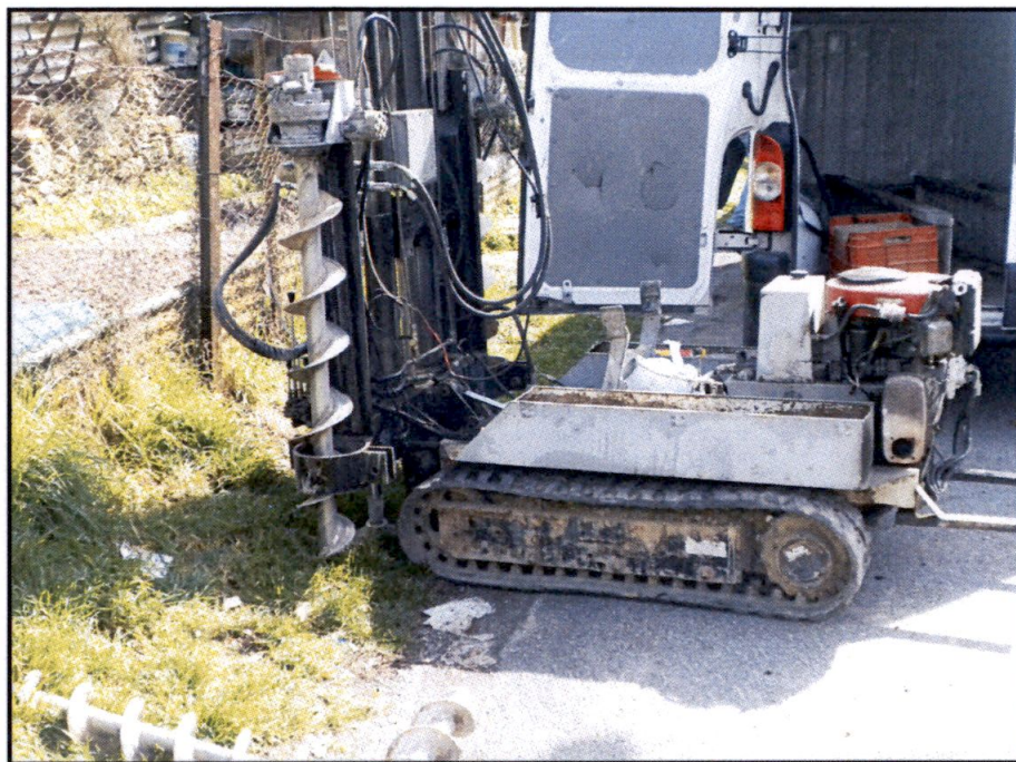
Foto 1 - Ubicazione della prova penetrometrica dinamica superpesante
