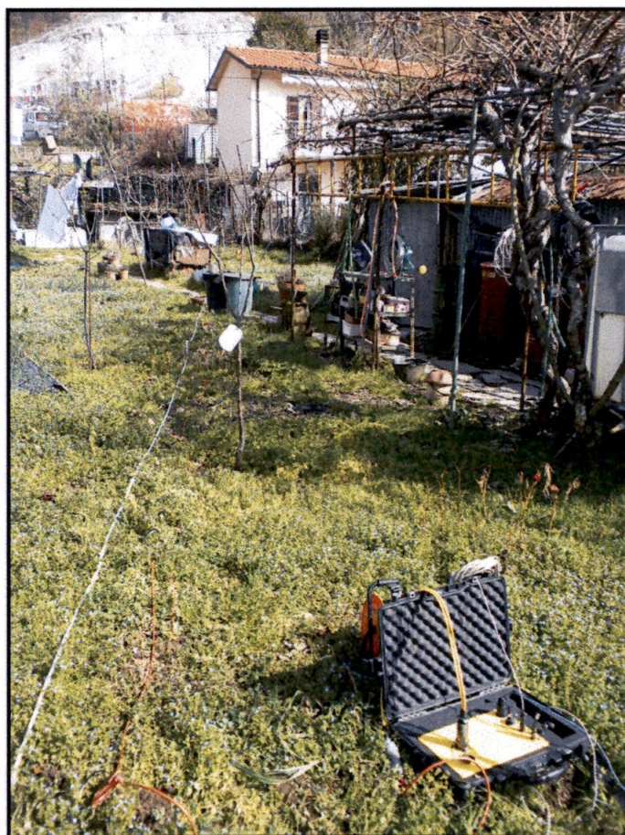
Foto 2 - Prova sismica MASW e stendimento in onde P
