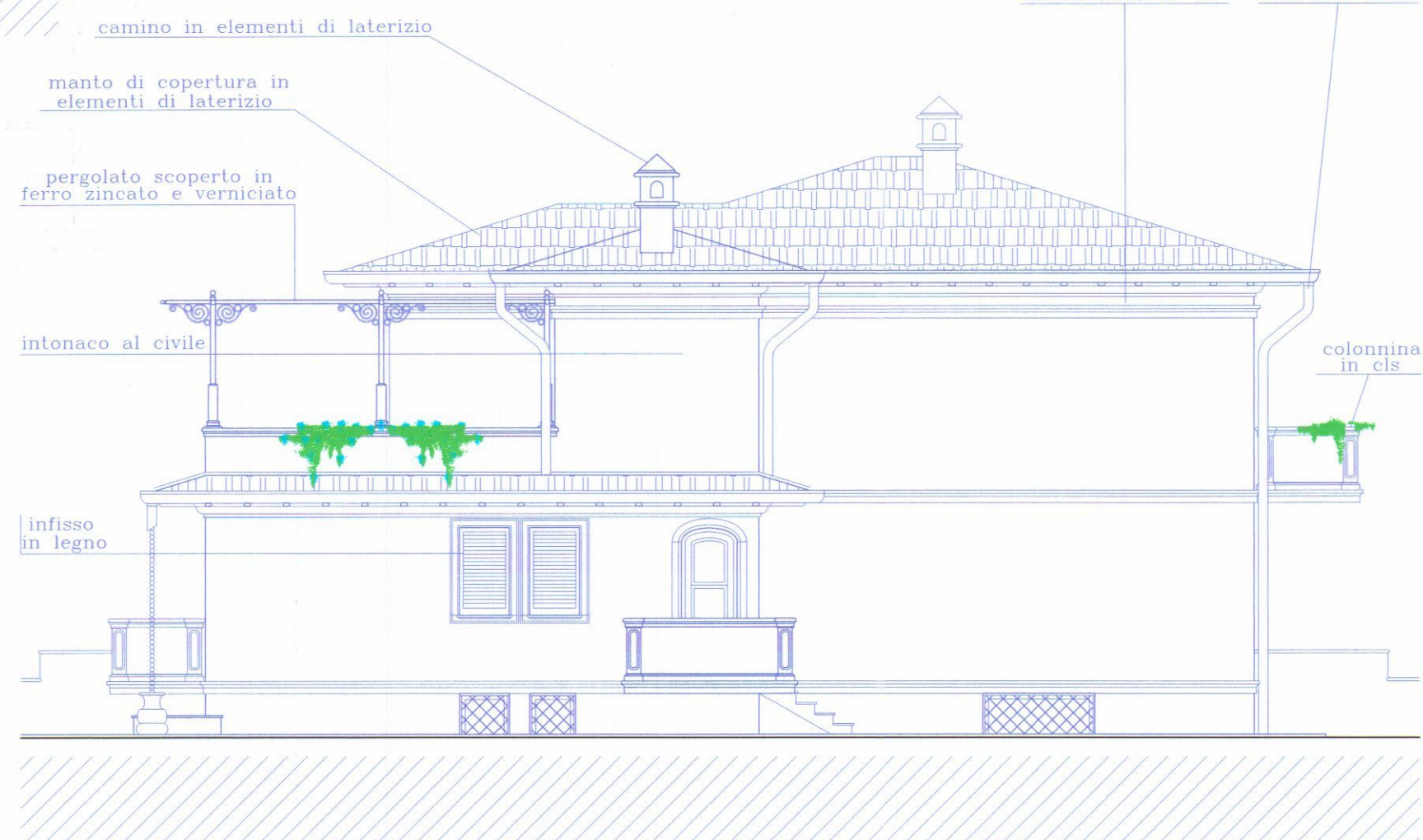
PROSPETTO NORD OVEST
