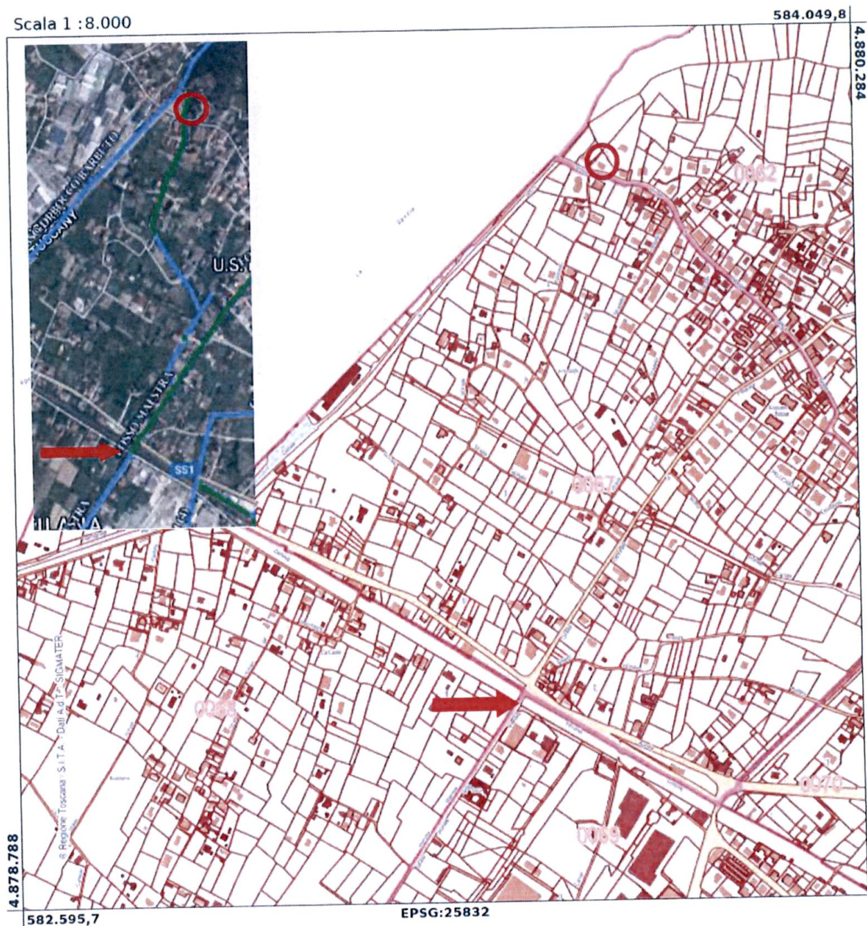
Fig. 3 C – Stralcio Catastale sovrapposto (scala 1 : 8000). Cerchiata in rosso la proprietà del richiedente. La freccia rossa indica l'inizio del tratto accatastato al demanio idrico dello stato della Fossa Maestra.
